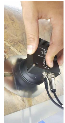
Inline-Kontrastmessung, rechts mit Offline-Aufsatz als Handgerät
